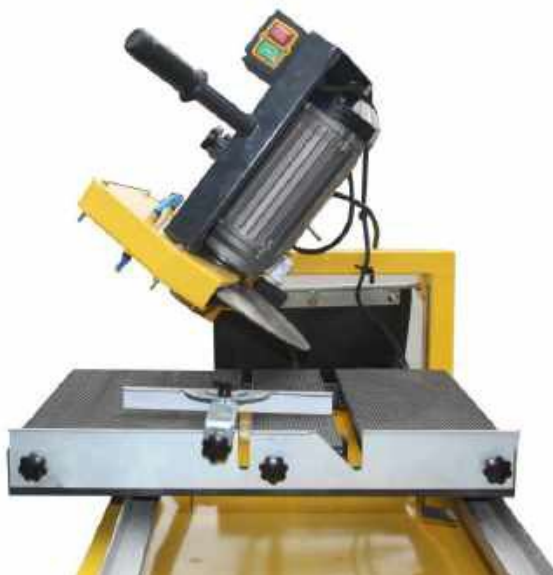
Piła podczas cięcia ukośnego na poziomie 45°
